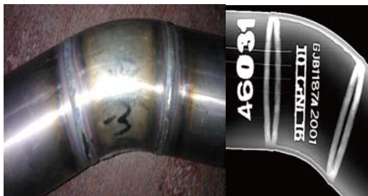
弯管焊缝检测
