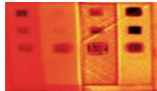
使用脉冲热成像检测CFRP复合材料，显示碳纤维蜂窝结构中的金属嵌件
