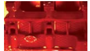
使用脉冲热成像检测带涂层发动机缸体的漆膜附着力
