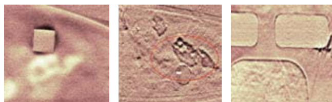
CFRP中的自然分层缺陷
