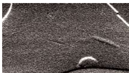
大厚度的CFRP结构中的自然缺陷
