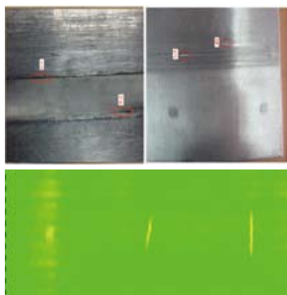
搅拌摩擦焊检测
